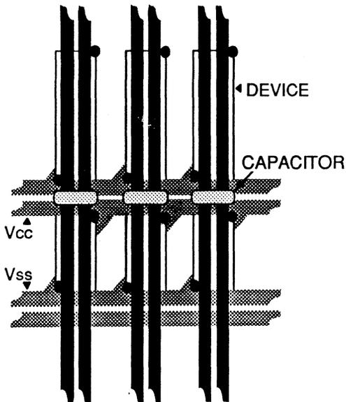
**V<sub>CC</sub>, V<sub>SS</sub> GRID SHOWING
