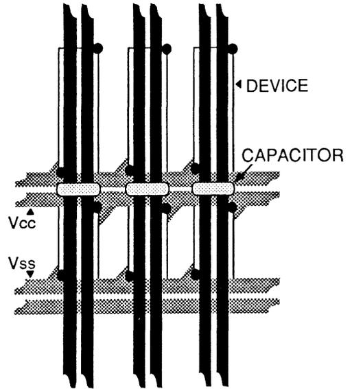
**V<sub>CC</sub>, V<sub>SS</sub> GRID SHOWING
