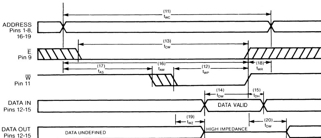
**RECOMMENDED AC OPERATING CONDITIONS** ( $-55^{\circ}\text{C} \leq T_A \leq 125^{\circ}\text{C}$ ) ( $V_{CC} = 5.0\text{V} \pm 10\%$ )
