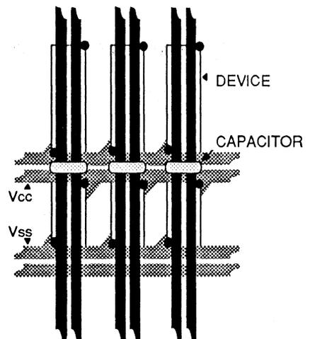
V<sub>CC</sub>, V<sub>SS</sub> GRID SHOWING
