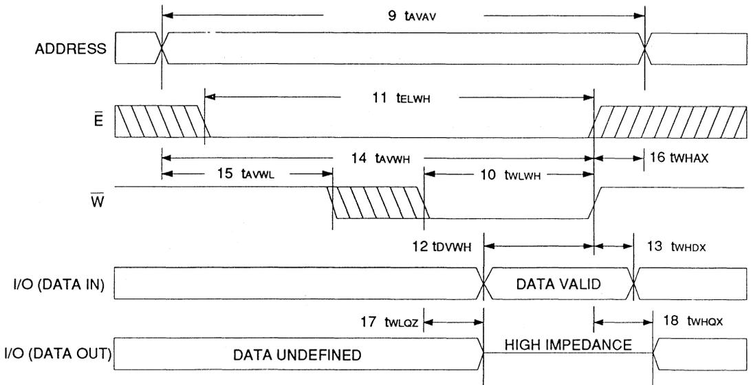
**RECOMMENDED AC OPERATING CONDITIONS** ( $-55^{\circ}\text{C} \leq T_A \leq 125^{\circ}\text{C}$ ) ( $V_{CC} = 5.0\text{V} \pm 10\%$ )
